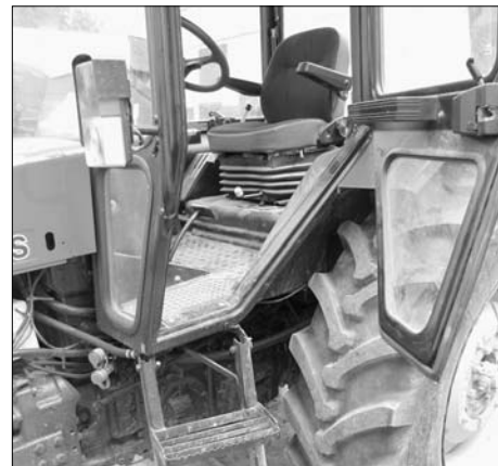
Stosowanie zasady trzypunktowego podparcia sprzyja bezpieczeństwu przy wchodzeniu i schodzeniu z ciągnika
